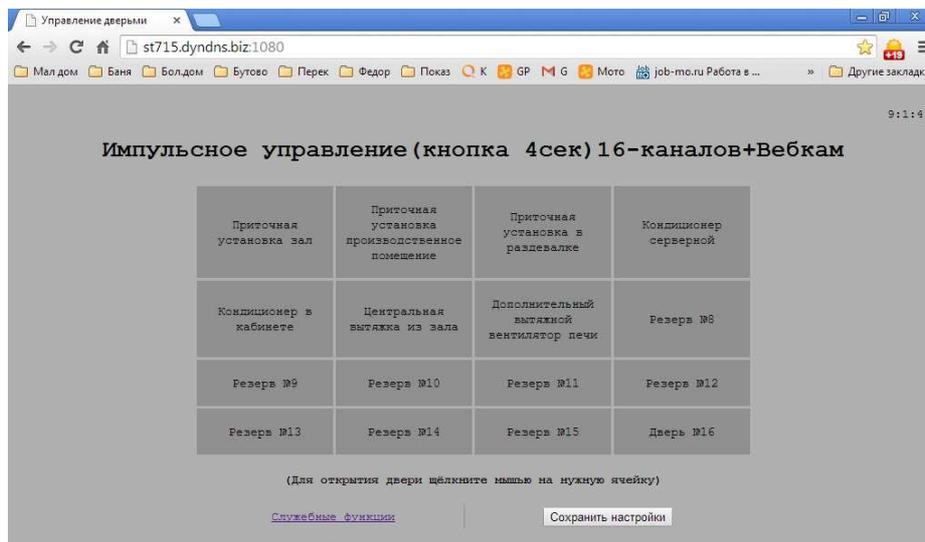
Устройство имеет импульсный выход на каждом канале из 16-ти (4сек), возможно применение устройства для локального и удаленного управления различными объектами, например дверьми, шлагбаумами, воротами и т.п.
